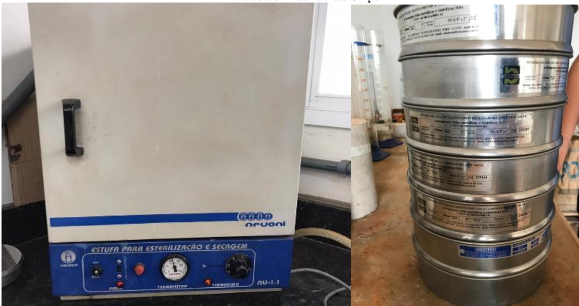
Figura 12 – Estufa e peneiras para o ensaio de granulometria por peneiramento do solo retirado do fundo do leito do Ribeirão da Onça
